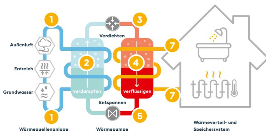
Die Wärmepumpe arbeitet ähnlich wie ein Kühlschrank, aber umgekehrt. Statt Kälte zu erzeugen, nimmt sie Wärme aus der Umgebung (Luft, Wasser oder Erde) auf und nutzt diese zum Heizen. Hier eine Erklärung zur Wirkungsweise:
